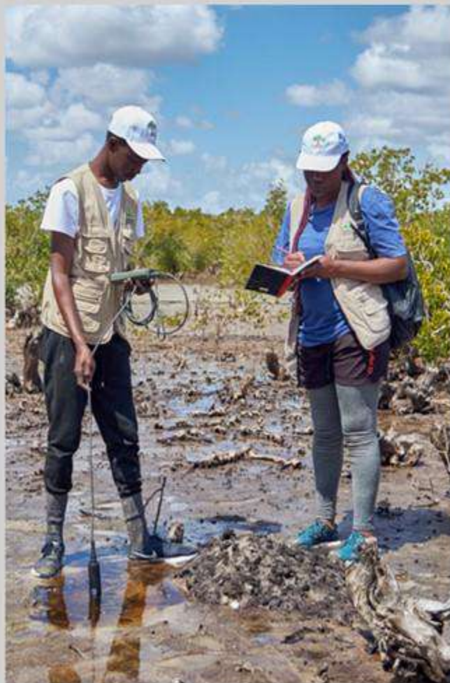
Medição com a sonda multiparamétrica (HANNA - HI-98194 Multiparameter)
