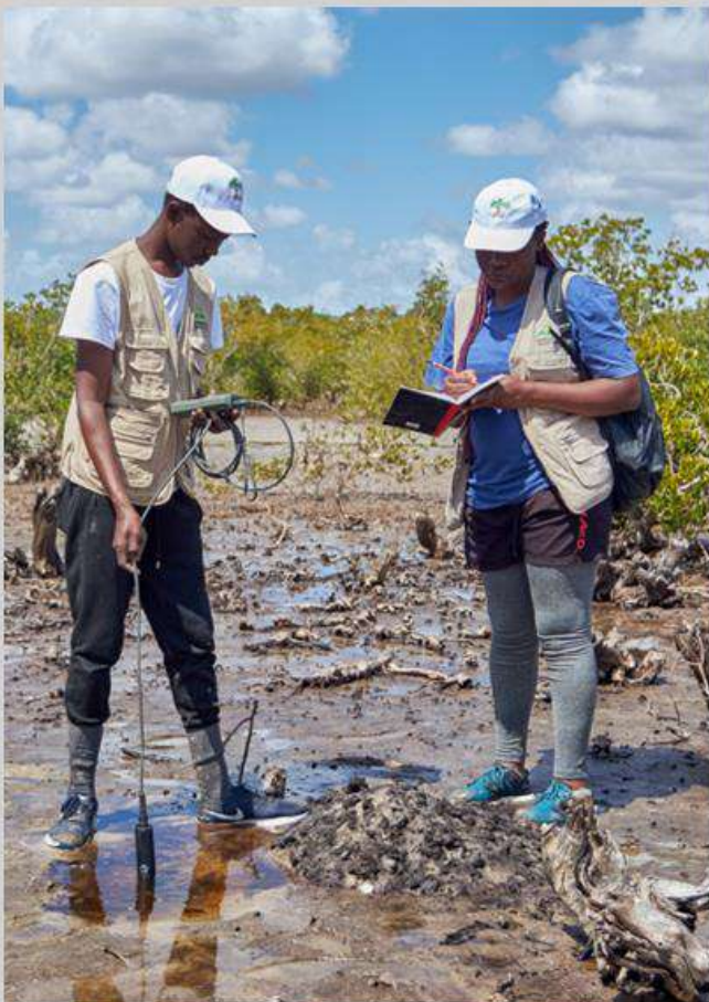
Medição com a sonda multiparamétrica (HANNA - HI-98194 Multiparameter)
