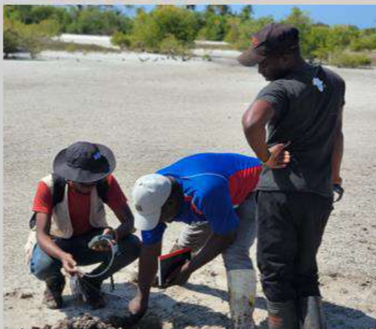
Medição com a sonda multiparamétrica (HANNA - HI-98194 Multiparameter)
